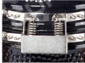
6. Пружинный механизм открывания
